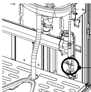
外部からの水道管(給水設備)と接続後コック開放し水漏れ有無確認、問題無ければ使用可能
