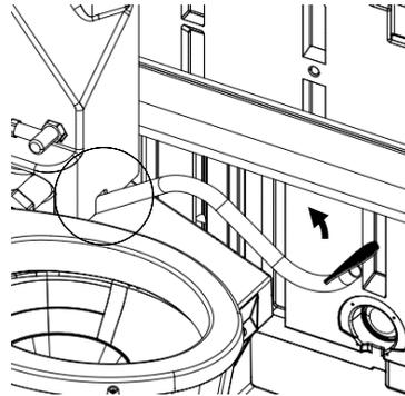
簡易水洗時は本水洗時に取り付けていた位置から一段上の凹凸へセットすることで仮置きすることが可能です
