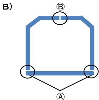
② トラ網金具で各パネル同士を挟み込んで、取り外したボルトと付属のナット(M8)で締めつけます。
