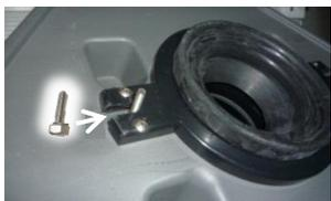
② 床フランジの両端にボルト(M8×35)を差し込みます。
