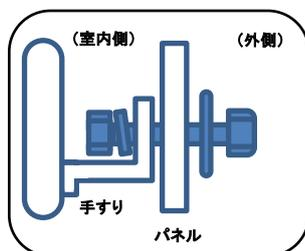
※側面へ取り付ける時にご注意いただきたいのは、手すりの切断面でご使用されるお客様がケガをしないよう、壁面で隠すように取付けをお願いします。
