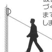
・設置面に水平方向に歩く場合は遠くから感知します。
